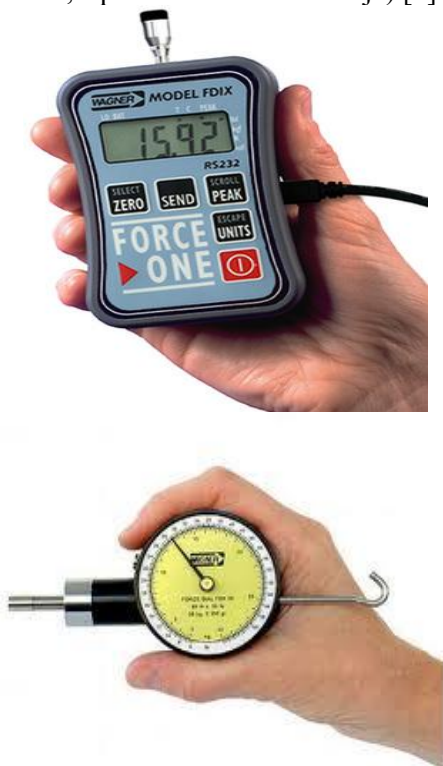
Slika 1. Prikaz manuelnog algometra (a) i slika digitalnog algometra (b)
