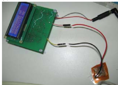
Sl. 5. Senzor položaja na bazi vrtložnih struja
