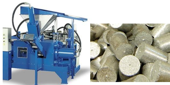
Slika 2.5: Presa za briketiranje metalne strugotine i izgled metalnog briketa
