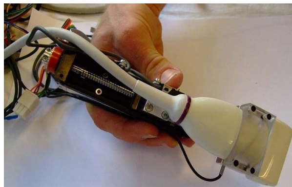
Sl. 4. Ručni, mehanički aktuirani sistemi za pomeranje ultrazvučne linijske sonde za 3d sonografiju, [7].
