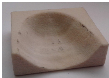
Sl. 8. Negativ baze proteze izrađen na 3D štampaču
