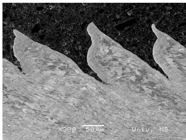
Sl. 2. Mikroskopski prikaz poprečnog preseka strugotine pri obradi pohabanim alatom
