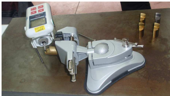
Sl. 5. Pozicioniranje uređaja u poziciju za merenje u pravcu normalnom na pravac sečiva
