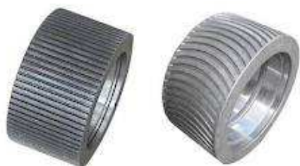
Slika 10. Valjci za presovanje (W-širina, OD-spoljni prečnik, ID-Unutrašnji prečnik)
