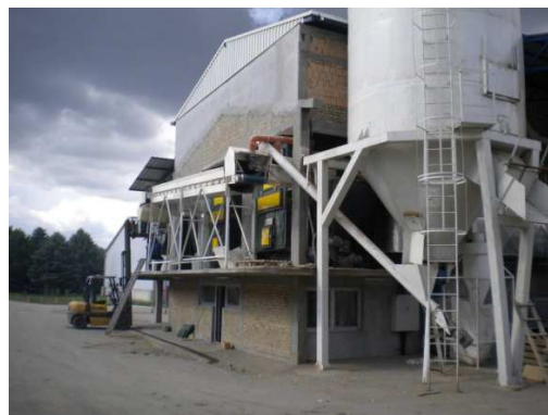
Slika 2. Čelo sušare sa silosnom ćelijom za oklasak i tri termogena
