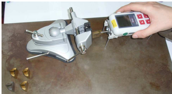
Sl. 4. Pozicioniranje uređaja u poziciju za merenje u pravcu sečiva
