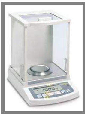
Sl. 4. Vaga na kojoj se sprovodi gravimetrijska analiza filtera
