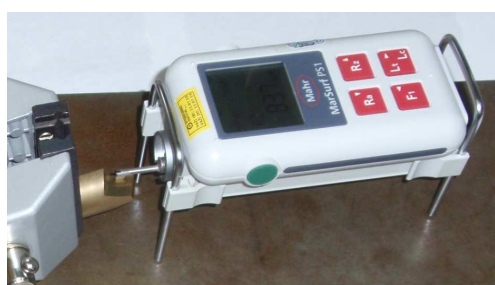
Sl. 6. Pozicioniranje uređaja u poziciju za merenje obraćajući pažnju na poziciju i pravac mernog pipka, merenje u pravcu sečiva.
