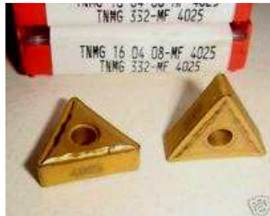
Fig. 6. TNMG 16 04 08 insert (Sandvik)
