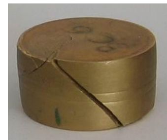
Sl. 8. Izgled uzoraka grupe BC posle deformisanja
