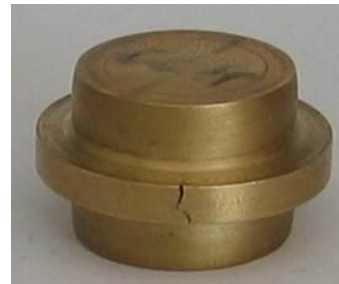
Sl. 6. Izgled uzoraka grupe CC posle deformisanja
