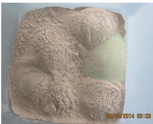
Sl. 2. Stakleni prah dobijen mlevenjem otpadne staklene ambalaže
