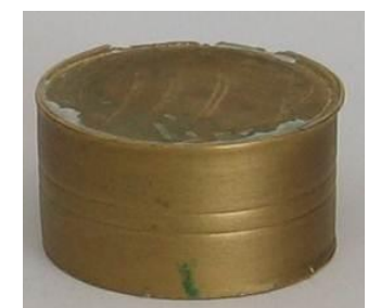
Sl. 9. Izgled uzoraka grupe R posle deformisanja
