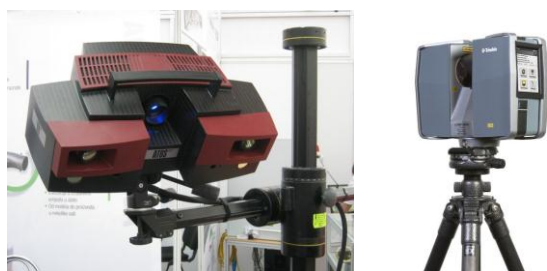
Sl. 3. Primeri uređaja za bezkontaktnu 3D digitalizaciju
