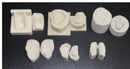
Sl. 8. Kalupi izrađeni tehnologijom vezivne 3D štampe
