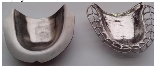
Sl. 4. Baza proteze dobijena novim (levo) i klasičnim (desno) postupkom
