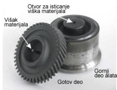
Sl. 4. Primena relaksirajućeg otvora u alatu kod toplog kovanja cilindričnih zupčanika sa kosim zubima [9,10]
