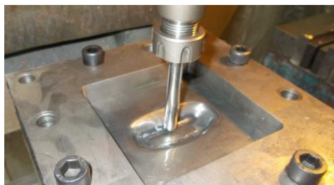
Sl. 2. Izrada baze proteze inkrementalnim deformisanjem
