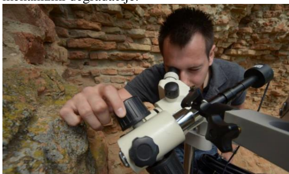
Sl. 5. In situ ispitivanja na Tvrđavi u Baču - mobilni stereo-optički mikroskop
