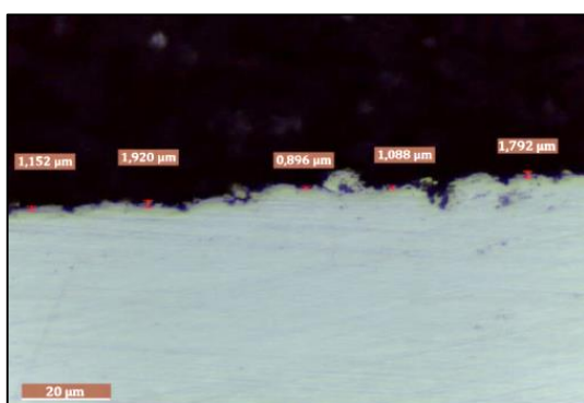
Sl. 2. Kontaminirani sloj uzorka iz prve korpe brušen sa P240 (SM)
