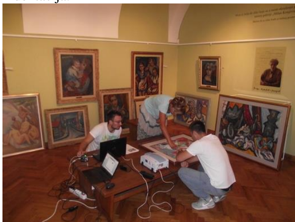
Sl. 1. Istraživački radovi na slikama Milana Konjovića (mobilni FTIR uređaj)
