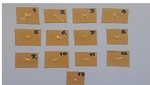
Sl. 3. Uzorci za DSC analizu koji su izvađeni iz središnje sekcije FDM uzorka pod odgovarajućim brojem
