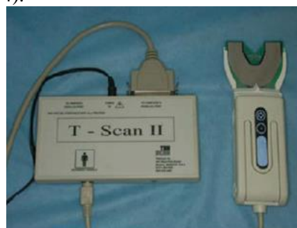
Sl. 4. Senzor T-Scan II sistema (desno) povezan sa centralnom jedinicom (levo)
