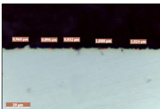
Sl. 3. Kontaminirani sloj uzorka iz prve korpe brušen sa P1000 (SM)
