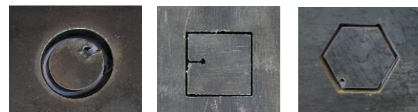
Slika 5. Prikaz širine reza pri obradi sečenjem materijala za različite procese obrade
