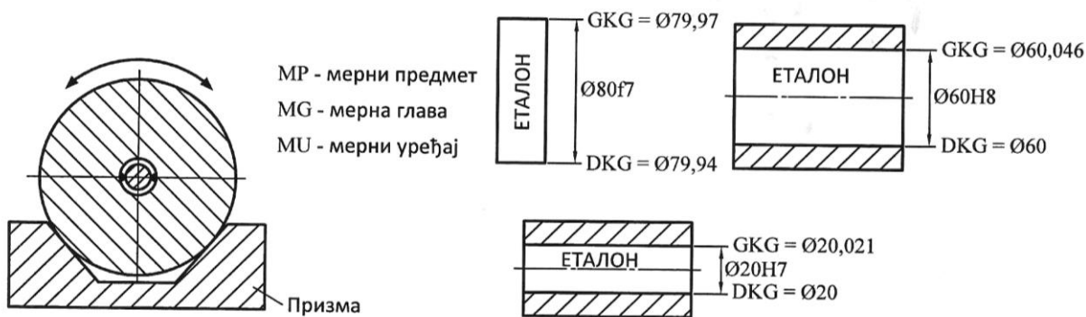
Sl. 5. Merno-kontrolna šema za merenje, odnosno kontrolu zadatah mernih veličina
