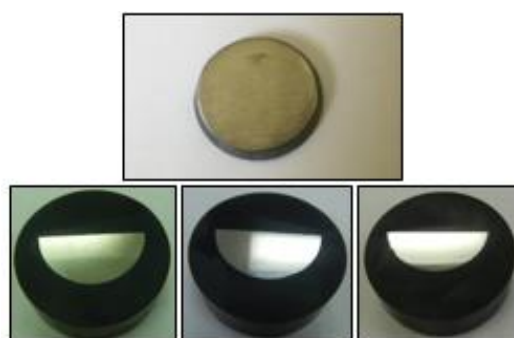
Sl 1. Uzorak za ispitivanje kontaminiranog sloja i pripremljeni uzorci (P 240, P 1000, poliran 1 µm)
