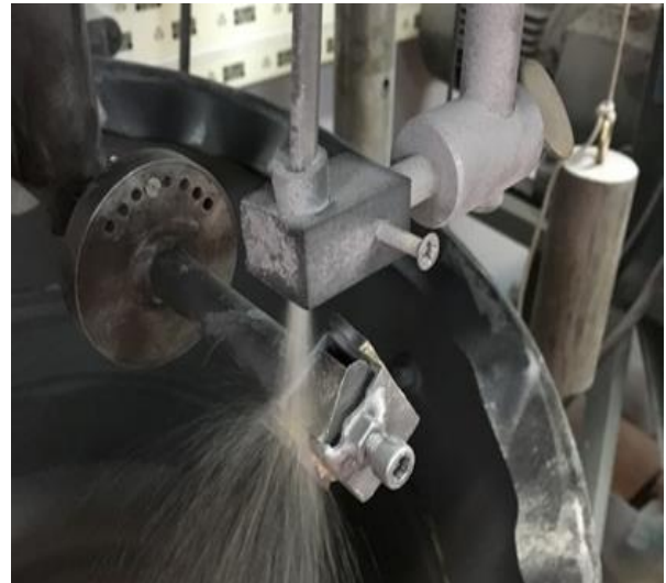
Sl. 3. Detalj uređaja za ispitivanje erozijskog trošenja pri kutu udara erodenta od 30°
