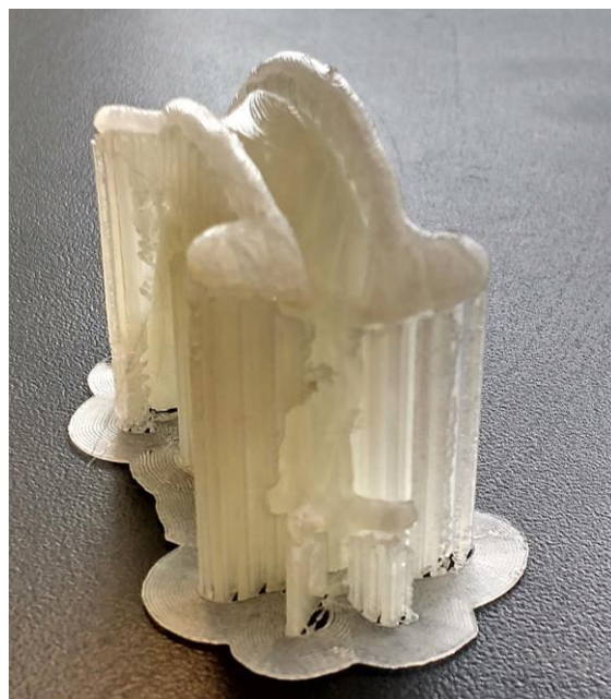
Sl. 8. Odštampan monoblok sa potpornim nosačima
