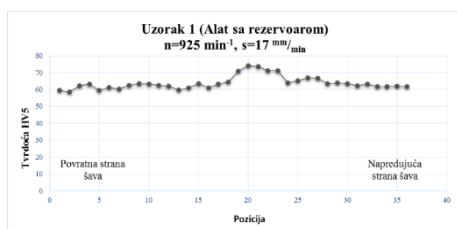
Sl. 4. Raspodela vrednosti tvrdoće za uzorak 1
