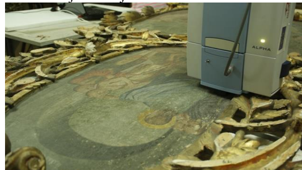
Sl. 2. Ispitivanje ikona Manastira Bezdin upotrebom portabl FTIR uređaja
