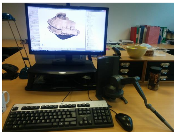
Sl. 5. Haptička ruka i monoblok pravljen u softveru Freeform Plus (v2016, Geomagic, 3d-Systems, USA)
