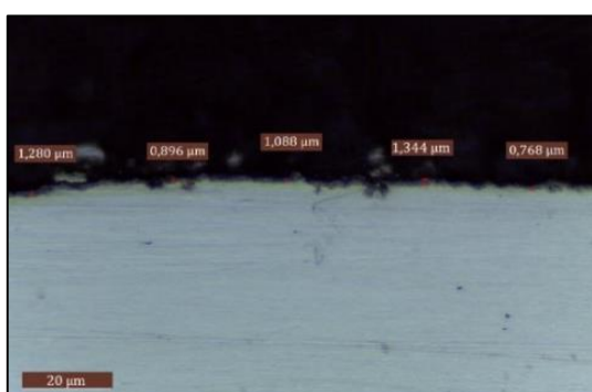
Sl. 4. Kontaminirani sloj uzorka iz prve korpe poliran sa dijamantskom suspenzijom 1 µm (SM)
