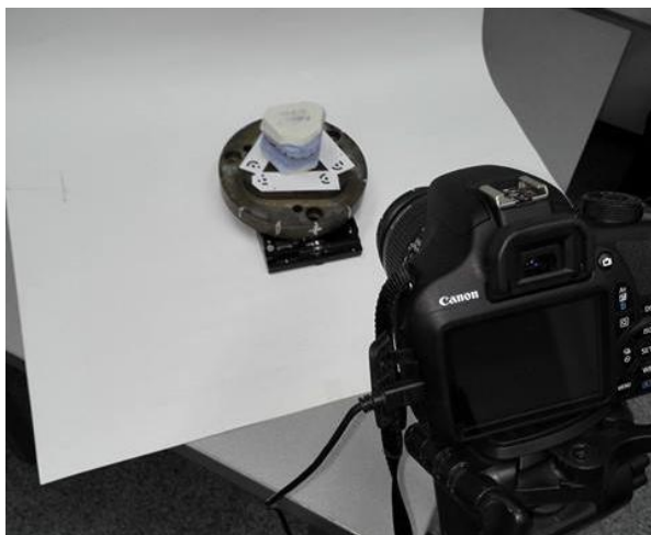
Sl. 3. Postavka fotogrametrijske 3D digitalizacije
